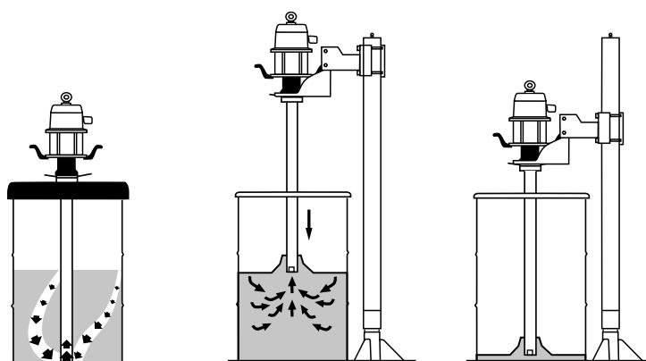
БЕЗ ЭКСТРУЗИОННОЙ ПЛАСТИНЫ. МОГУТ ВОЗНИКАТЬ ВОЗДУШНЫЕ КАНАЛЫ И КАРМАНЫ
