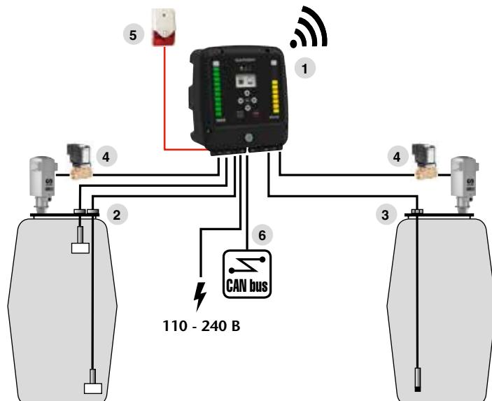
U-tank **1** может контролировать до двух танков. Каждый танк может быть оснащен датчиками нижнего и верхнего уровней **2** с манометром **3** для контроля остатков в танке в реальном времени. U-tank **1** может также контролировать работу насоса, открывая или закрывая электромагнитный воздушный клапан **4**, который предотвращает работу насоса всухую или попадание воздуха в линию подачи масла, если в танках нет масла.
