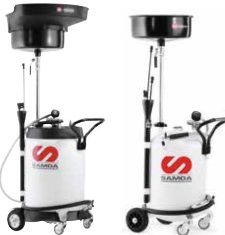
**Комбинированные установки для откачки и слива с прозрачной колбой.** Установки с 10-литровыми прозрачными колбами, которые могут использоваться как вакуумный резервуар и позволяют быстро оценить состояние отработанного масла. Могут использоваться удаленно, если внутри стальной емкости создан вакуум. Опорожнение через выпускной шланг 1,5 м путем создания давления в емкости. Поставляется с предохранительным клапаном, защищающим от чрезмерного давления.
