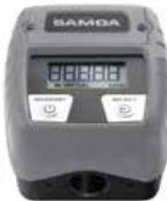
**366 010** Счетчик с овальными шестернями для AdBlue®/DEF, 1/2" BSP (F) Счетчик с овальными шестернями, сделанный из ХПВХ, нержавеющей стали и LCP (полимер) для AdBlue®/DEF. Цифровой дисплей работает от двух алкалиновых батареек AAA. Впускная/выпускная резьбы 1/2" BSP (F). Производительность: 1-50 л/мин.
