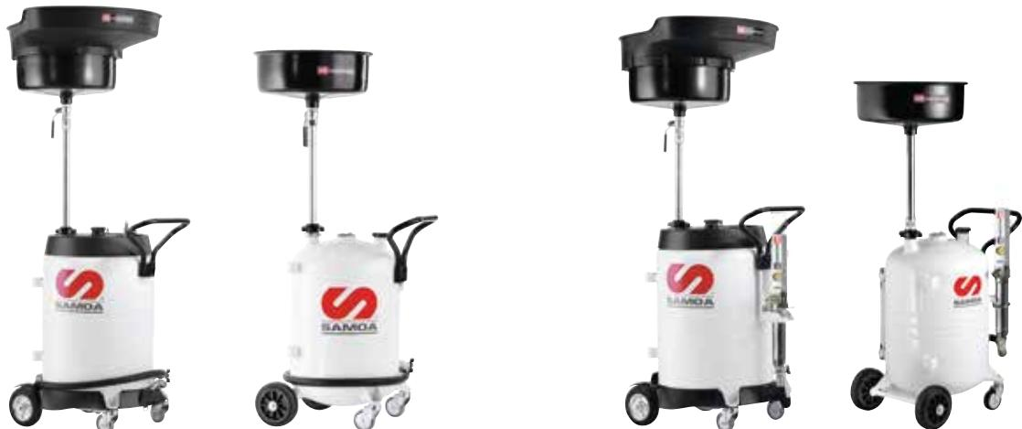
**Самотечные маслосборники с опорожнением давлением.** Опорожнение через выпускной шланг 1,5 м путем создания давления 0,5 бар в емкости. Поставляется с предохранительным клапаном, защищающим от чрезмерного давления.
