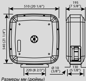
Алюминиевый корпус и кронштейн, композитная катушка, может использоваться шланг до 15 м x 1/2".
