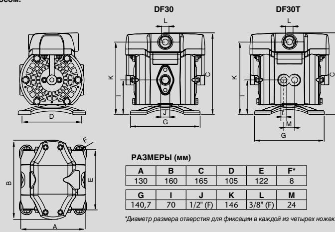
Диаметр размера отверстия для фиксации в каждой из четырех ножек.
