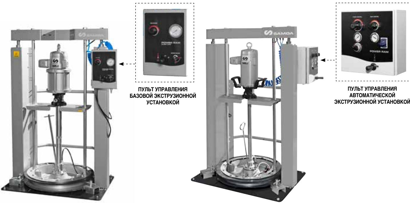
Насосы для консистентной смазки PumpMaster 45 и PumpMaster 60 установлены на экструзионную пластину для работы с высоковязкими, трудными для всасывания смазками напрямую из 185 кг бочек.
