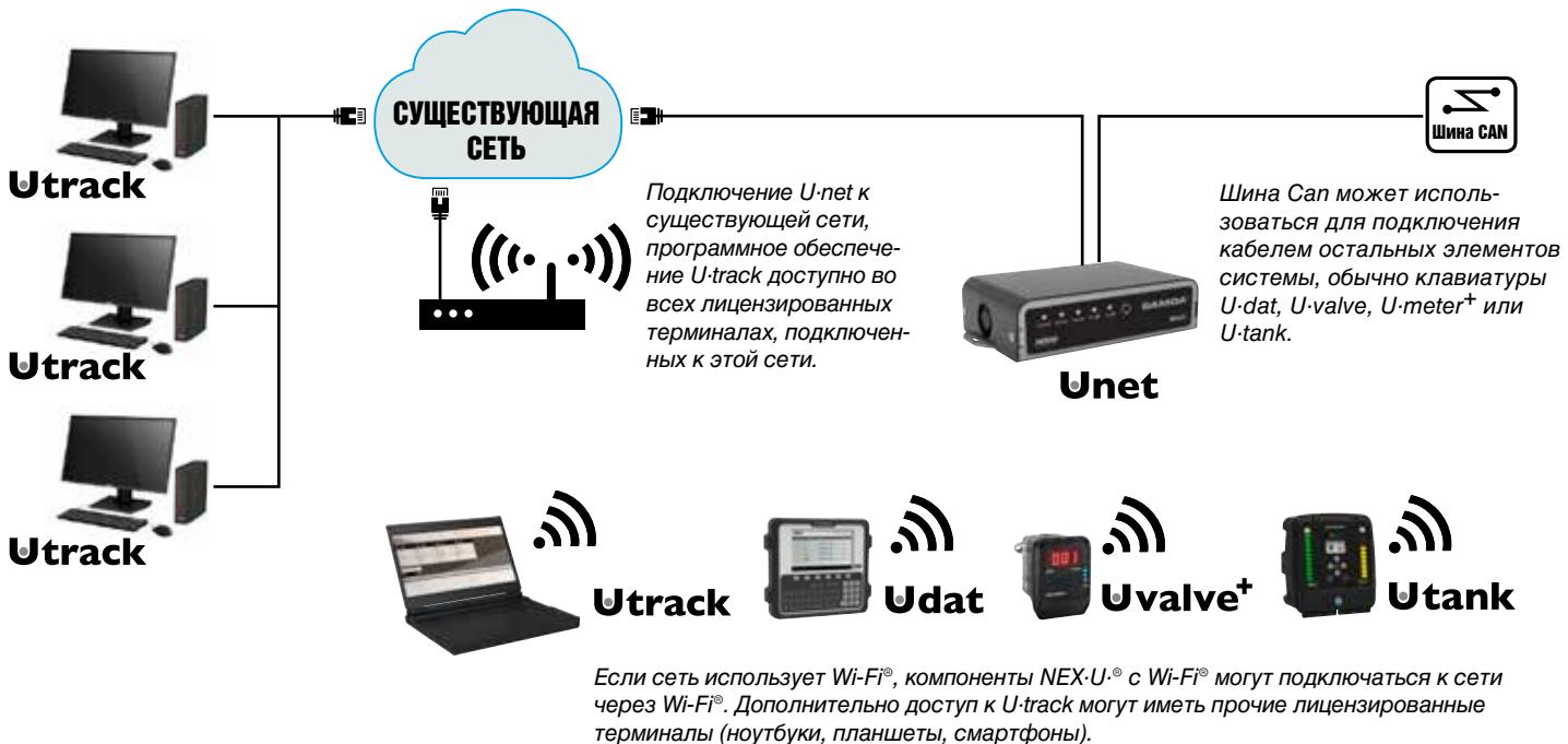
Если сеть использует Wi-Fi®, компоненты NEX-U-® с Wi-Fi® могут подключаться к сети через Wi-Fi®. Дополнительно доступ к U-track могут иметь прочие лицензированные терминалы (ноутбуки, планшеты, смартфоны).
