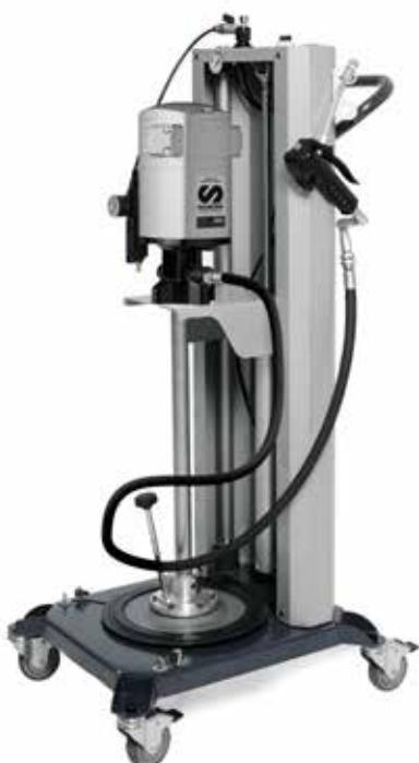
Мобильная установка специально спроектирована для использования с липкими и высоковязкими консистентными смазками, которые трудно перекачивать (до NLGI-3). К нижнему концу насоса прикреплена экструзионная пластина. Насос установлен на пневмоцилиндр, который поднимает насос, чтобы заменить пустое ведро. Пневмоцилиндр оказывают давление вниз, вдавливая насос и следящую пластину в смазку, и таким образом способствуя работе насоса, позволяя качать очень вязкую консистентную смазку.
